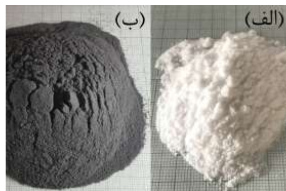
شکل ۱- پودر HDPE 3840UA در دو حالت (الف) خالص و (ب) با افزودنی گرافیت
