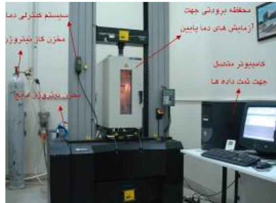
شکل ۵- شمای کلی تجهیزات مورد نیاز جهت انجام آزمایش‌ها در دمای اتاق و 60^{\circ}\text{C}
