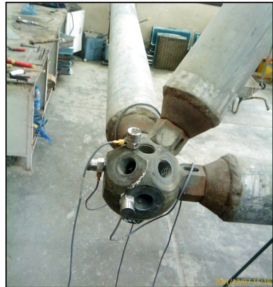
شکل ۷- سه شتابسنج برای اندازه‌گیری پاسخ سازه در سه جهت
