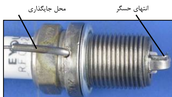
شکل ۶- حسگر دمای نصب شده روی الکتروود منفی
