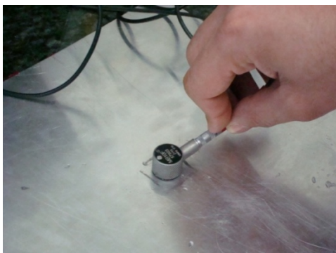
شکل ۱۲- تست قسمت معیوب
