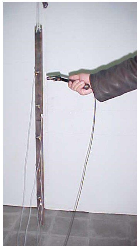
شکل ۷- تیر تحت آزمایش مودال کلاسیک
