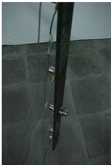
شکل ۹- نصب جرم اضافی روی هر شتابسنج
