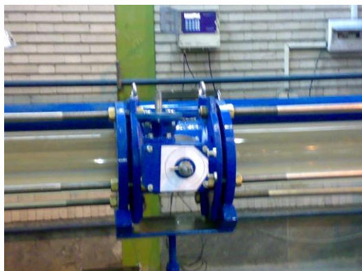
شکل ۷-۵: نمای شیر پروانه‌ای نمونه نصب شده در تست ریگ
