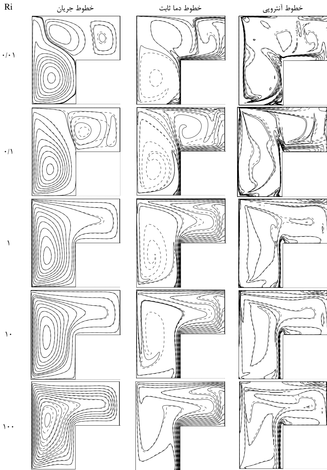
شکل ۳- خطوط جریان، خطوط دما و خطوط آنتروپی کل، برای سیال (---) و نانوسیال (___) در \phi=0.04 ، در اعداد ریچاردسون مختلف برای حالت (V0-)
