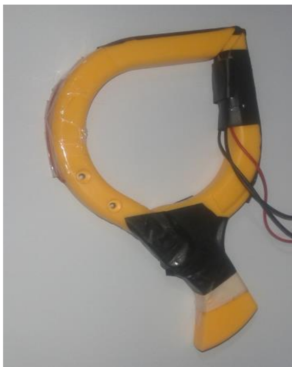
شکل ۱۵: نمونه آزمایشگاهی دست‌بند ضد برق‌گرفتگی
