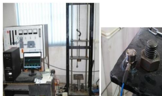
شکل ۱۱- شماتیک دستگاه سقوط وزنه و سنسور شتاب سنج
