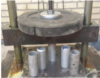
شکل ۹- نحوه‌ی قرار گیری نمونه‌ها در دستگاه سقوط وزنه
