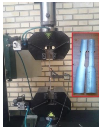
شکل ۲- نمونه‌های بریده شده با وایرکات و نحوه‌ی بستن در
