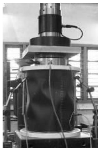
شکل ۲ مود کمانش ایجاد شده در نمونه تحت تست پس از وقوع کمانش [۱۷]
