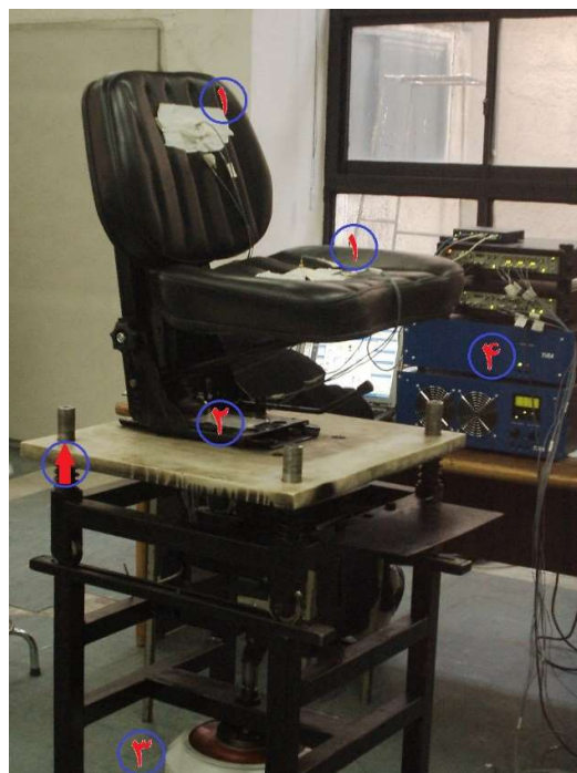
شکل ۹- صندلی، تجهیزات اندازه‌گیری و جهت شتاب ورودی در راستای عمودی (شماره گذاری مطابق شکل شماره ۸)
