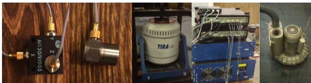
شکل ۸- قسمت‌های مختلف دستگاه اندازه‌گیری ارتعاش و ثبت آن: به ترتیب از راست به چپ (۱) شتاب‌سنج سه جهتی، (۲) شتاب‌سنج یک جهتی، (۳) دستگاه لرزاننده، (۴) تقویت کننده و (۵) کمپرسور هوا
