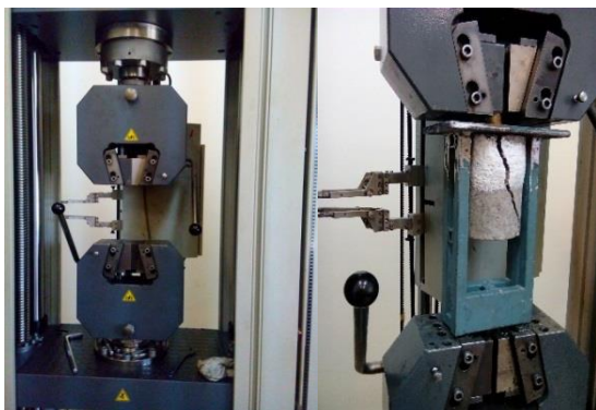
شکل ۷- نمایش دستگاه و نحوه انجام تست بیرون کشیدگی
