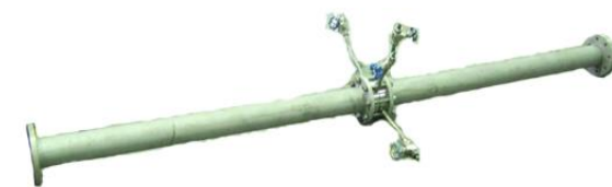
شکل ۸- نمونه ساخته شده اریفیس دبی‌سنج به همراه متعلقات آن
