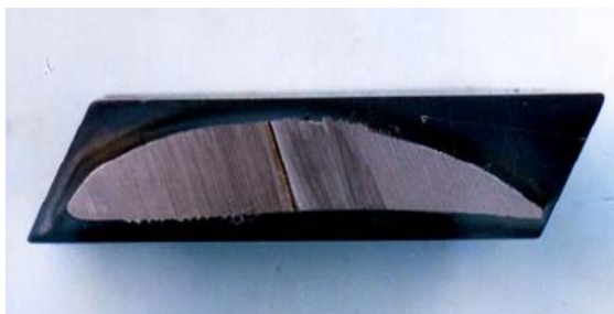
شکل ۵- محل برش پره نزدیک ریشه جهت بررسی لایه سطحی
