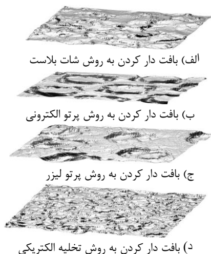
شکل ۱- انواع روشهای بافت دار کردن ورقها [۱۳]
