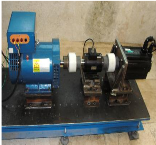
شکل ۱- تصویر شاسی، سروو موتور، تورک متر و ژنراتور
