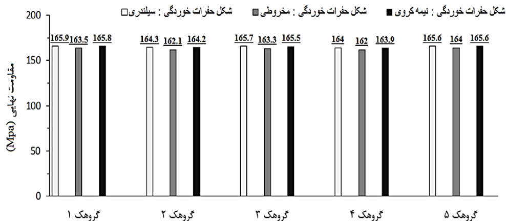
شکل ۶- مقاومت نهایی ورق‌های گروهک‌های پنج‌گانه مربوط به گروه‌های ۱ تا ۳ (ورق‌های فولادی با مقاومت بالا)
