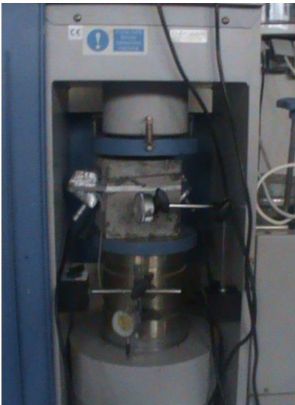
شکل ۲: اندازه‌گیری تغییر شکل‌های محوری و جانبی هم‌زمان با عبور موج در نمونه بتن تحت فشار تک‌محوره
