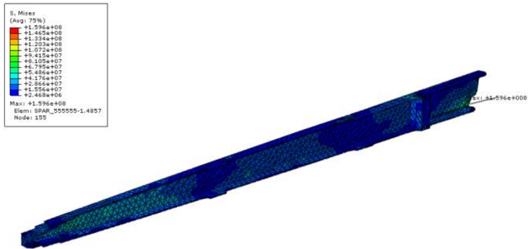
شکل ۲۵: کانتور تنش میزز به همراه مش‌بندی در مدل پوسته منعطف برای اسپار جلو
