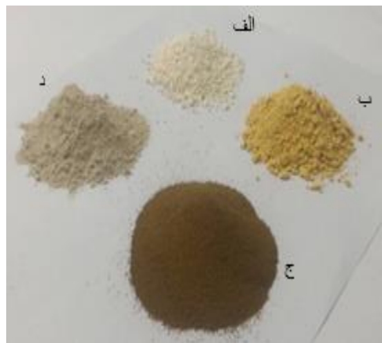
شکل ۲- مواد افزودنی الف) سیلیکات سدیم، ب) پسماند، ج) خاک، د) آهک
