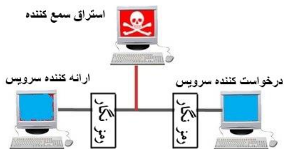
شکل ۵- تبادل داده با استفاده از رمزنگار
