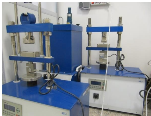
شکل ۲: تصویر دستگاه اندازه‌گیری مقاومت فشاری (سمت راست) و مقاومت خمشی (سمت چپ)
