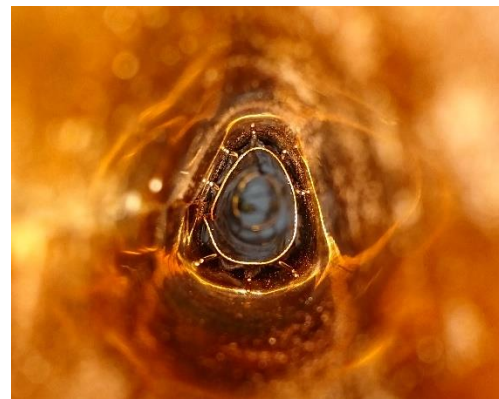
ب- نمای داخلی لوله پیش از قرارگیری هسته شکل ۴- بادامکی برای مطالعه انتقال حرارت
