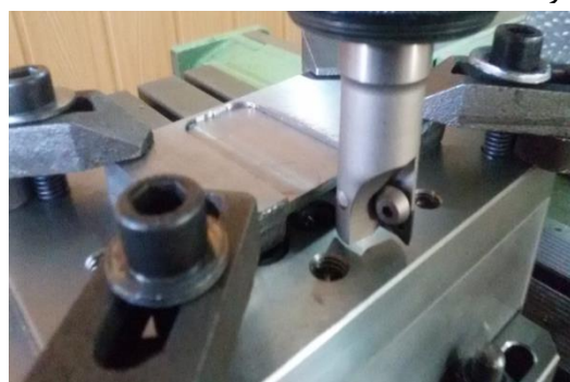
شکل ۲-۵- بستن ابزار، قطعه و انجام تنظیمات لازم.
