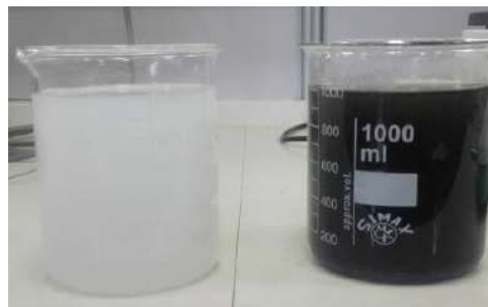
شکل ۲- تصویر نمونه نانوسیال اکسید مس (رنگ مشکی) و اکسید آلومینیوم (رنگ شیری) ساخته شده در آزمایشگاه
