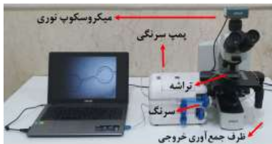
شکل ۹- تصویری از ست آپ آزمایشگاهی شامل: میکروسکوپ نوری، پمپ سرنگی و رایانه به منظور انجام تست‌های آزمایشگاهی بر روی تراشه.
