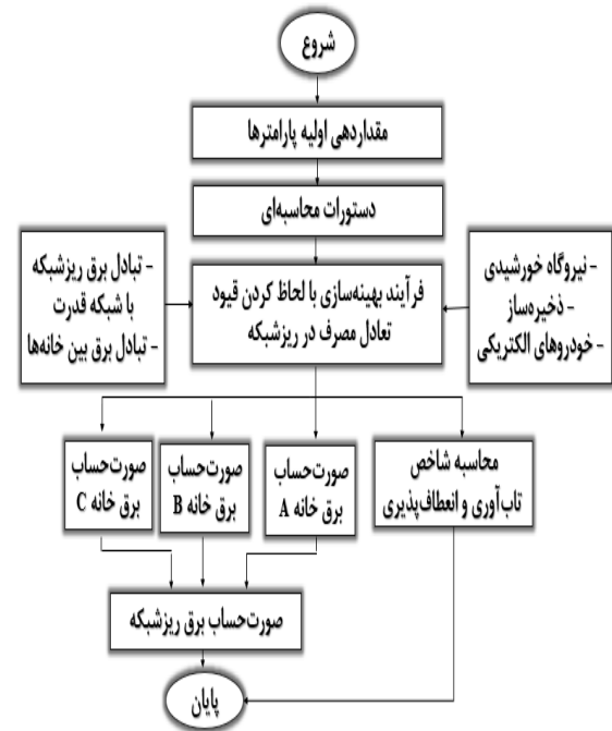
شکل ۳- مراحل مدل‌سازی پیشنهادی برای بهینه‌سازی ریزشبه مسکونی
