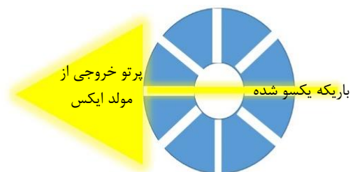
شکل ۲: طرح کلی یک چرخ برشگر و اثر آن بر پرتوی
