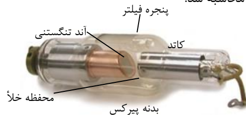
شکل ۳: نمایی از نمونه واقعی تیوب ایکس
