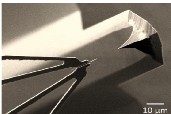
شکل ۱- میکروگیره در حال نزدیک شدن به نوک AFM [۱۵]
