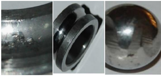
شکل ۲- اجزای بلبرینگ با عیب ایجاد شده در آنها ( از راست به چپ: عیب در گلوله، عیب در حلقه داخلی و عیب در حلقه خارجی) [۳۵]
