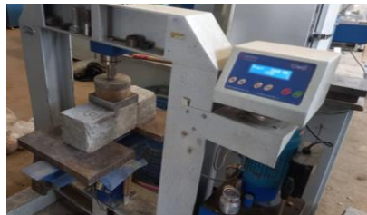
شکل ۲- نحوه اتصال بتن‌های جدید و قدیم و مراحل انجام آزمایش مقاومت برشی
