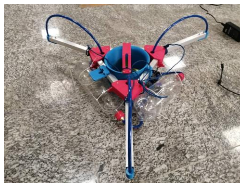
شکل ۲- مدل ساخته شده از سیستم پهپاد آزمایشگاهی سه محرکه با رانشگرهای گاز سرد
