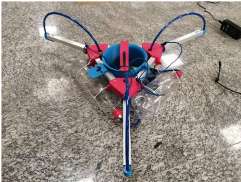
شکل ۲ - مدل ساخته شده از سیستم پهپاد آزمایشگاهی سه محرکه با رانشگرهای گاز سرد
