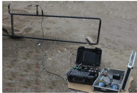
شکل ۱۳- ساز و کار شبیه‌ساز حسگر سرعت
