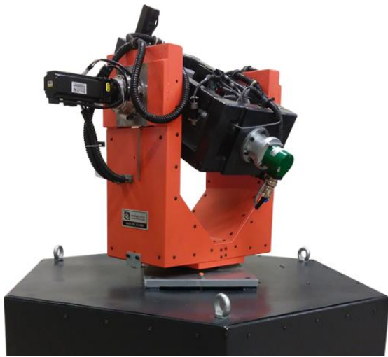
شکل ۱۴- میز شبیه‌سازی سه درجه آزادی
