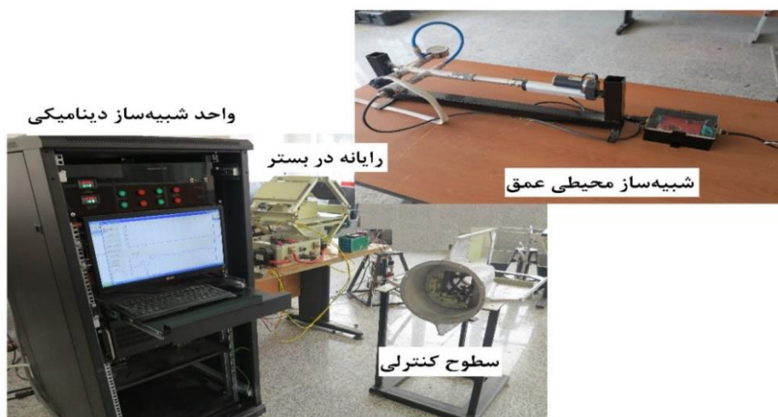
شکل ۱۷- مجموعه تجمیع‌یافته آزمایشگاه HIL یک رونده زیرآبی خودگردان
