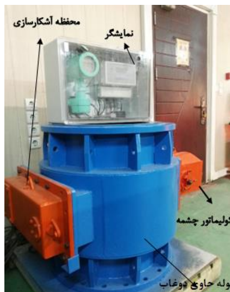
شکل ۱۰- غلظت‌سنج هسته‌ای بهینه‌سازی شده و مورد استفاده جهت داده‌گیری تجربی
