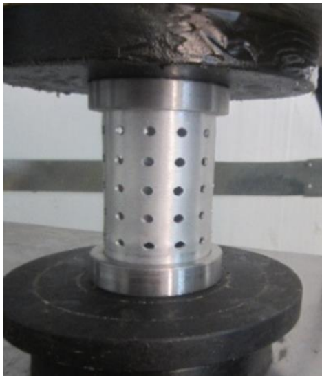
شکل ۳- لوله سوراخ‌دار بر روی فک پرس
