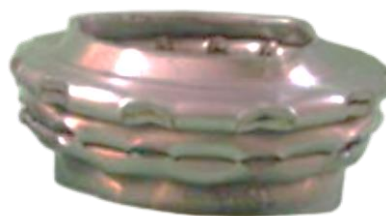
شکل ۵- لوله فولادی پس از لهیدگی
