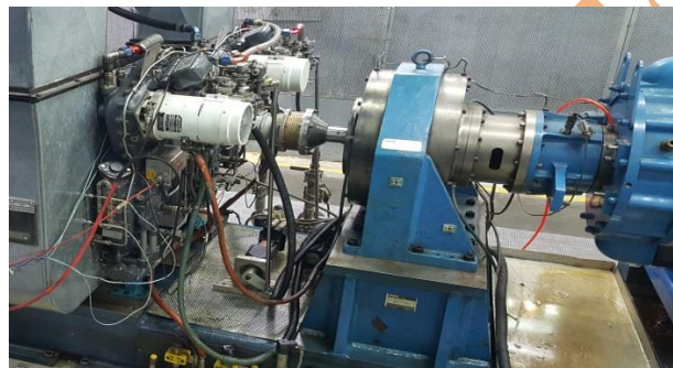
شکل ۱- جایگاه آزمایش موتور بالگرد و دینامومتر مورد مطالعه [۲۷]
