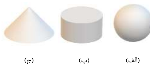
شکل ۲- انواع شکل هندسی الکترودهای برقگیر مورد مطالعه، (الف) الکترودهای کروی، (ب) الکترودهای استوانه ای، (ج) الکترودهای مخروطی.
