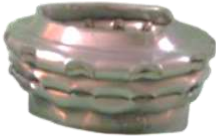
شکل ۵- لوله فولادی پس از لهیدگی
