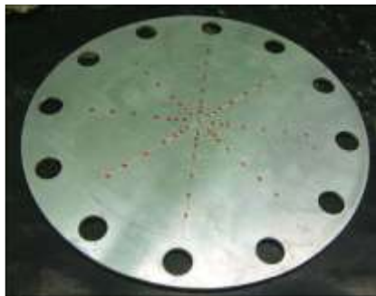
شکل ۲: علامت گذاری ورق‌ها برای ایجاد سهولت در اندازه‌گیری مقادیر کرنش و تعیین پروفیل شکل نهایی ورق
