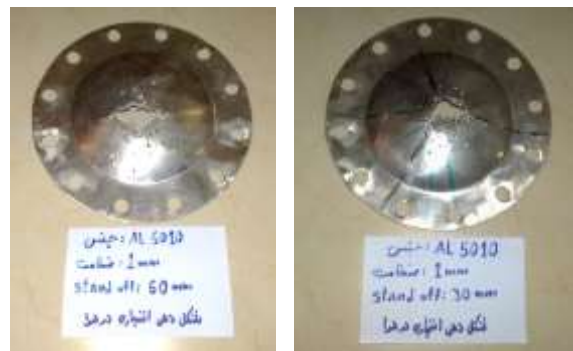
شکل ۶: شکل دهی انفجاری ورقهای آلومینیومی با ماده منفجره PETN در هوا در حالت پارگی (شکست)
