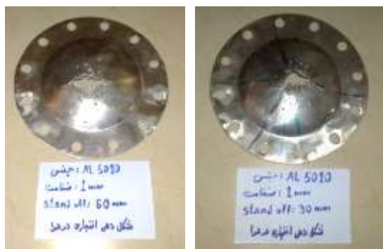
شکل ۶- شکل دهی انفجاری ورق‌های آلومینیومی با ماده منفجره PETN در هوا در حالت پارگی (شکست)
