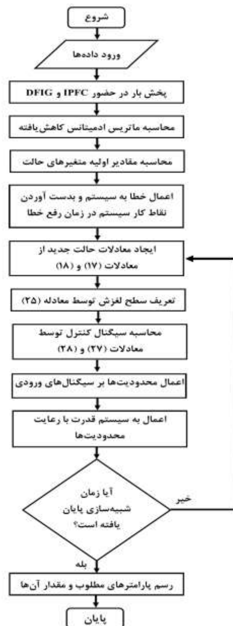
شکل ۴- فلوچارت شبیه‌سازی سیستم قدرت در حضور IPFC و DFIG با اعمال FTSMC
